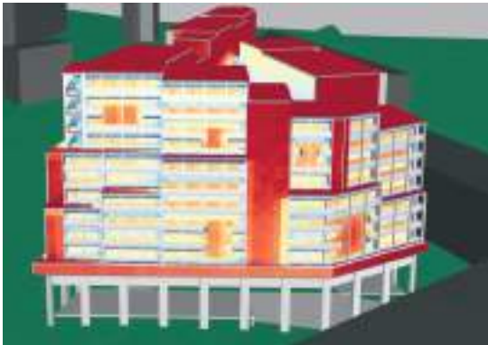
L'étude d'ensoleillement de la façade Ouest permet d'évaluer la capacité des balcons / poteaux à protéger du soleil
